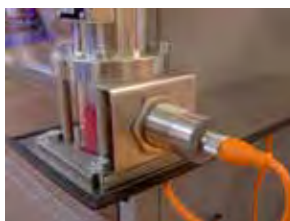
Ilustr. 3 hasta 5: Control del nivel de granulado, polvo o producto a granel
