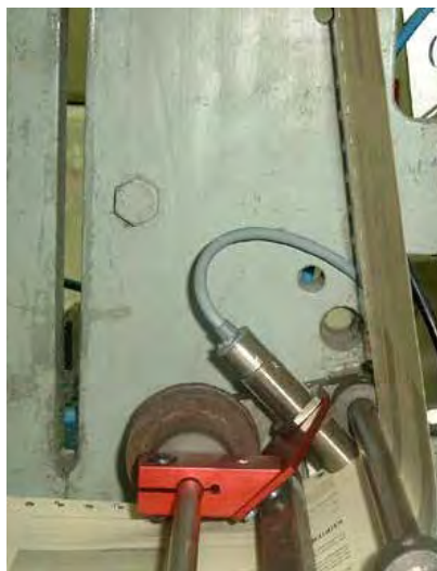
Ilustr. 2: Detección de una línea de pegamento con sensores de montaje enrasado
