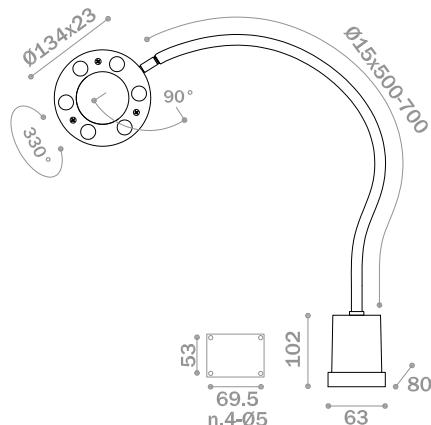
Lámpara led con lupa y brazo articulado para iluminación y control de precisión.
